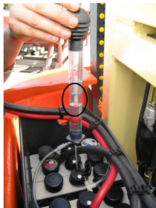
Figuur 6-8. Het soortelijk gewicht van de elektrolyt meten
